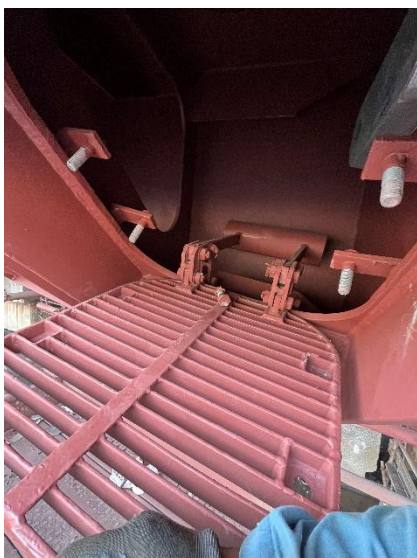
Foto 9 – Detalhe da grade externa e interior da caixa de mar. Limpa e pintada.
