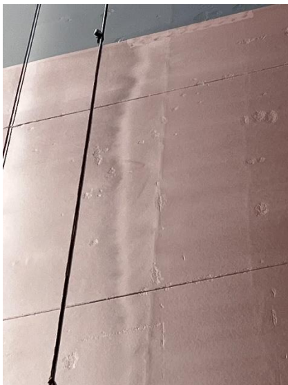
Foto 7 - Detalhe do costado à meia nau de boreste. Casco limpo e pintado.
