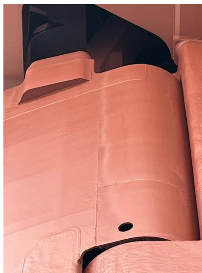
Foto 10 – Detalhe da base de articulação do leme. Limpo e pintado.
