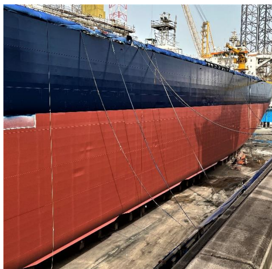
Foto 1 – Costado de bombordo, limpo e pintado. Sem incrustações. Tinta aplicada.
