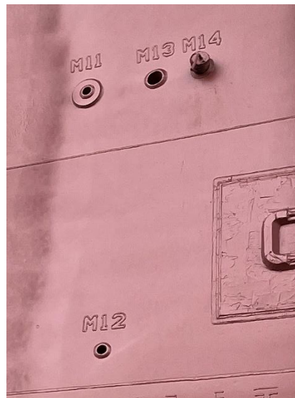
Foto 12 – Detalhe do costado de boreste. Limpo e tinta aplicada.
