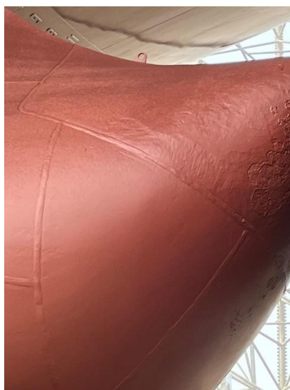
Foto 2 – Detalhe do bulbo de proa, limpo e pintado.
